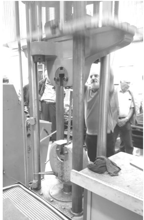
Kollege Gerhard Stradtner, Leiter des Materialprüfamtes, führt einen Zugversuch an Baustahl vor [Foto: VIB]
