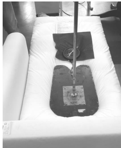
Prüfung der Belastungsfestigkeit von Sitzmöbeln [Foto: VIB]
